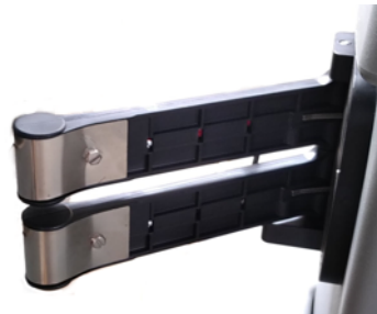
Ladekontakte an der Ladestation
