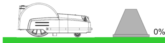
Abbildung 146: Längssteigung der Ladestation
