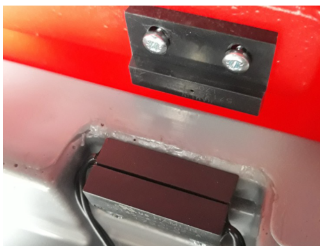
Abbildung 227: Positionierung der Magnete und der Reed-Relais
